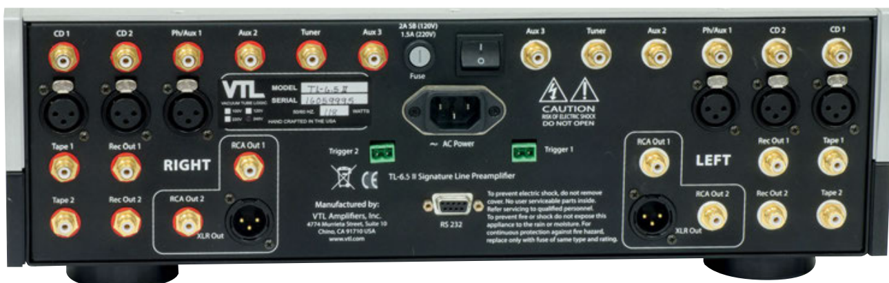
La dotazione di input/output è particolarmente ampia. Abbiamo 3 ingressi duplicati in bilanciato (nel TL7.5 sono 4), 2 ingressi e uscite Tape solo RCA, e 3 uscite, 2 RCA e una bilanciata (2 nel TL7.5). Inoltre abbiamo 2 trigger (invece di 4) per comandare l'accensione e lo spegnimento di altri apparecchi e infine una porta seriale RS-232 bidirezionale (ovvero non solo è possibile ricevere i comandi da un'unità di home-automation, ma le eventuali regolazioni da frontale o telecomando vengono "rispedite" a detta unità).
